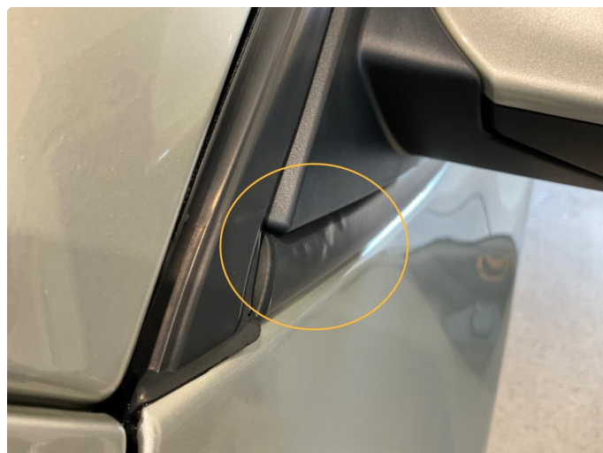
1.2 Viser tegn til korrosjon/ rust under folie. Kan også bare være at folie har løsnet.
