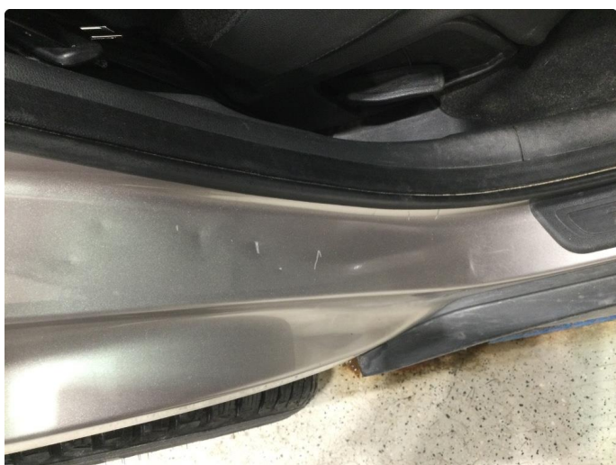
1.2 Noen riper og småbulker
