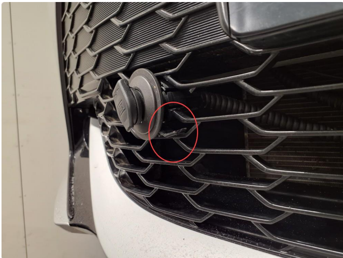
1.4 Noe merker etter montering av DEFA.
