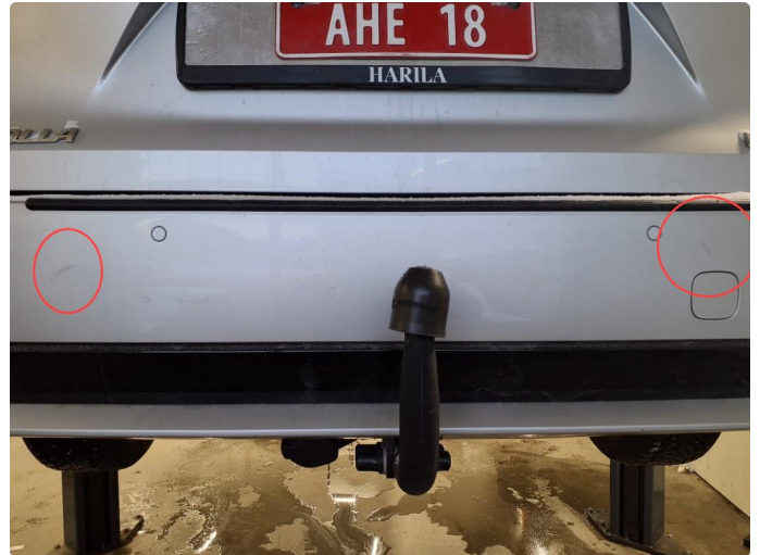
1.3 Riper på støtfanger bak.
