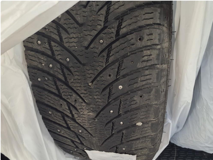
1.3 Noen pigger mangler på 2 av vinterdekk
