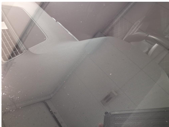
1.7 En del små steinsprut på frontrute.
