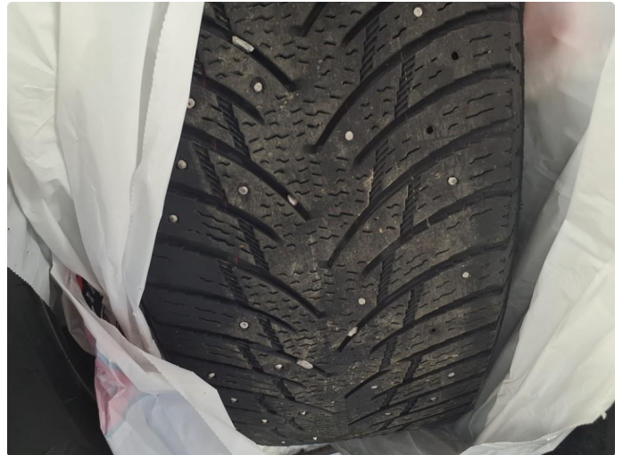
1.3 Noen pigger mangler på 2 av vinterdekk
