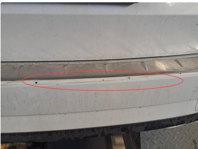
1.4 Slitasje på innlastningssone til bagasjerom.
