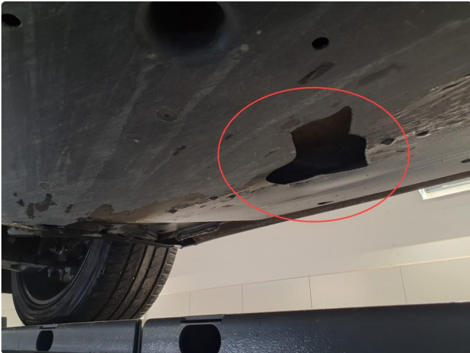
1.1 Skadet beskyttelsesplate underside
