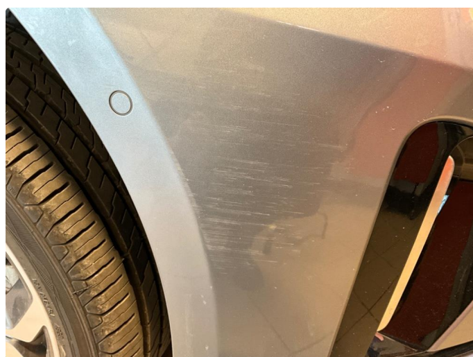
1.2 Riper og lakkskade på støtfanger foran.
