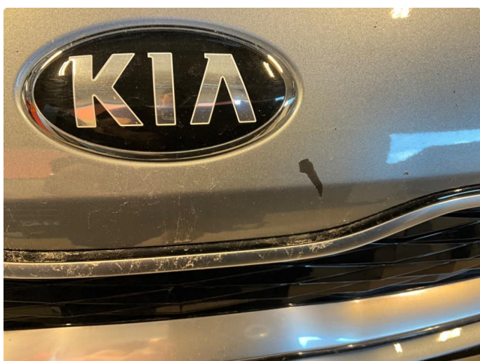
1.2 Riper og lakkskade på støtfanger foran.
