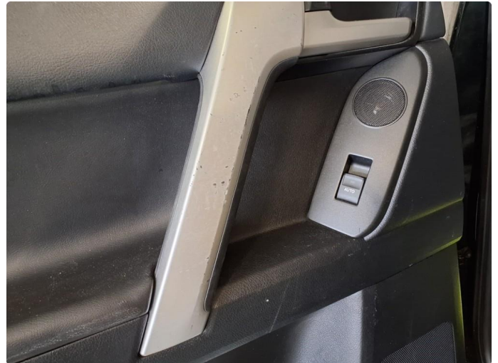
2.1 Noe slitasje på dørhåndtak, høyre og venstre bak.
