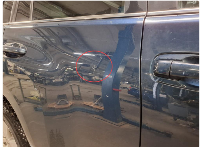
1.3 Riper på høyre bakdør.
