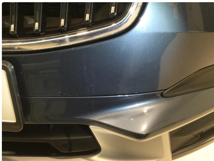
1.5 Noe steinsprut på frontfanger
