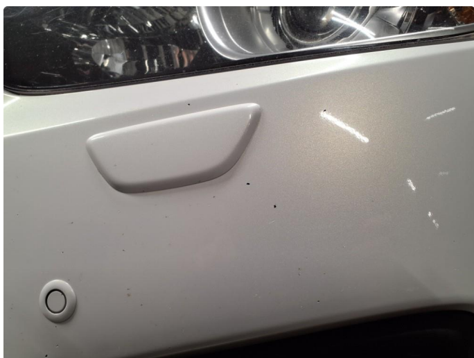
1.6 Riper i støtfanger
