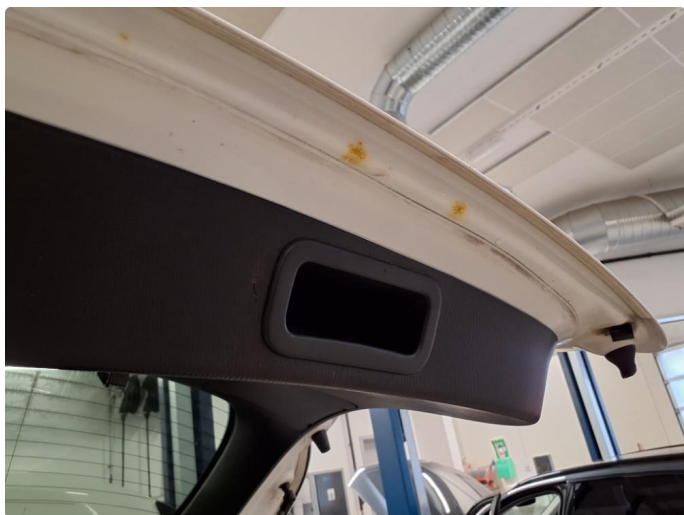
1.4 Rust i fals
