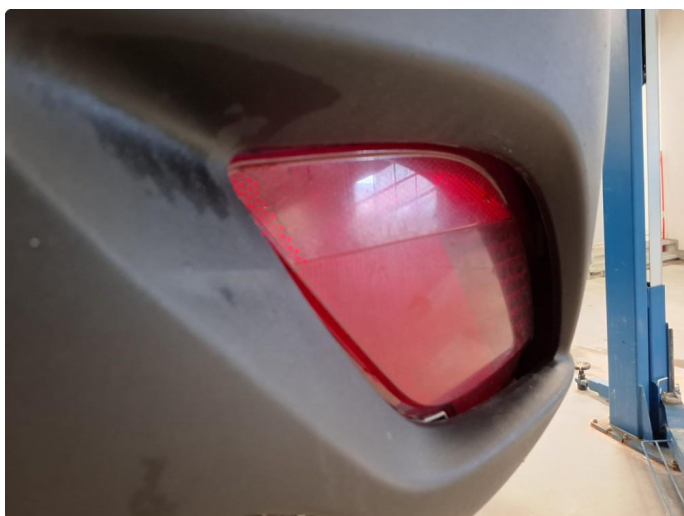
2.2 Tåkelys - defekt/sprukket glass
