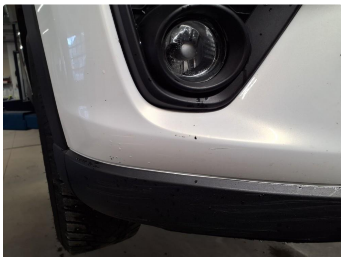
1.6 Riper i støtfanger
