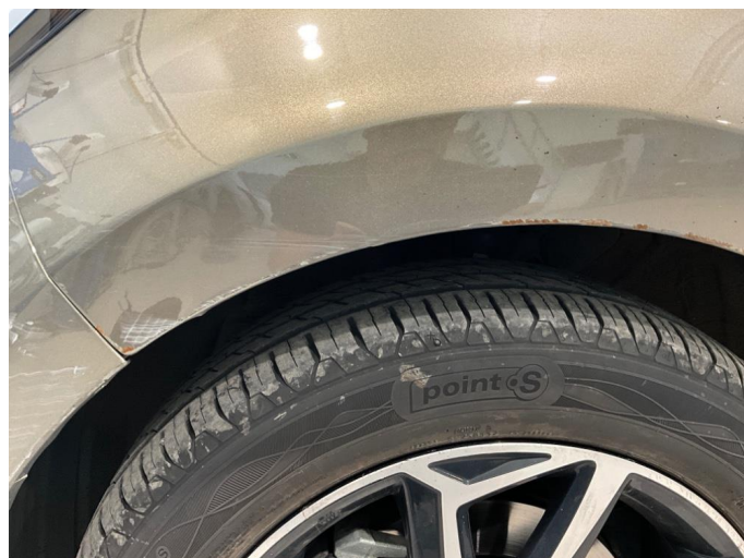
1.2 Skjerm skadet. Ser ut som at bilen har vært borti noe da den følger støtfanger bak til førerdør.
