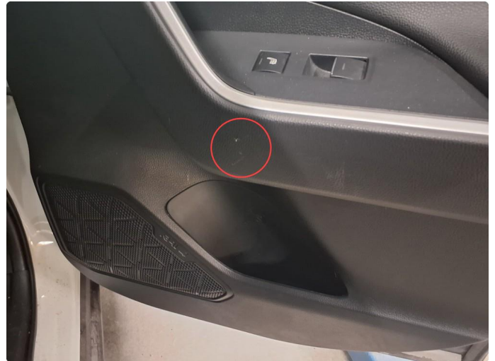
2.1 Skadet/merker etter utstyr
