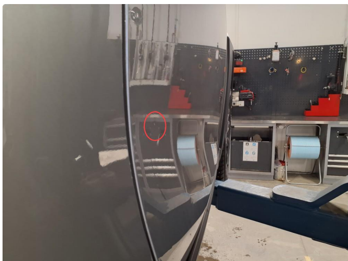
1.1 Liten bulk med lakkskade
