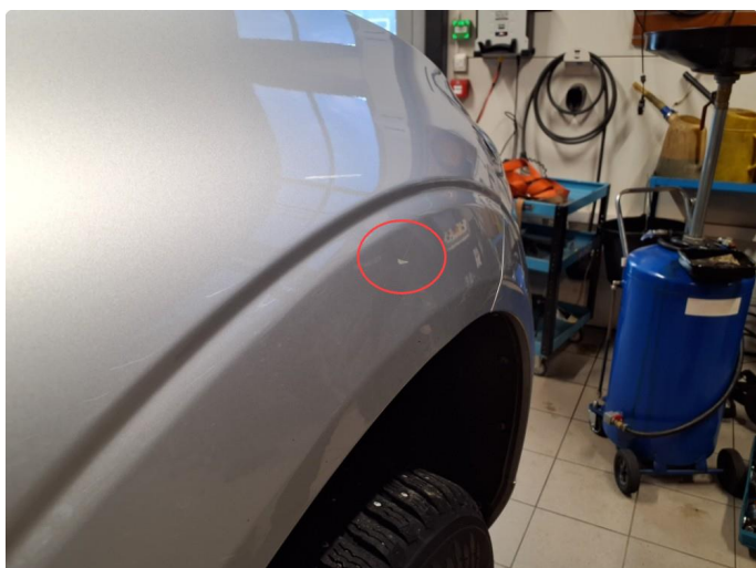
1.3 Liten bulk med lakkskade
