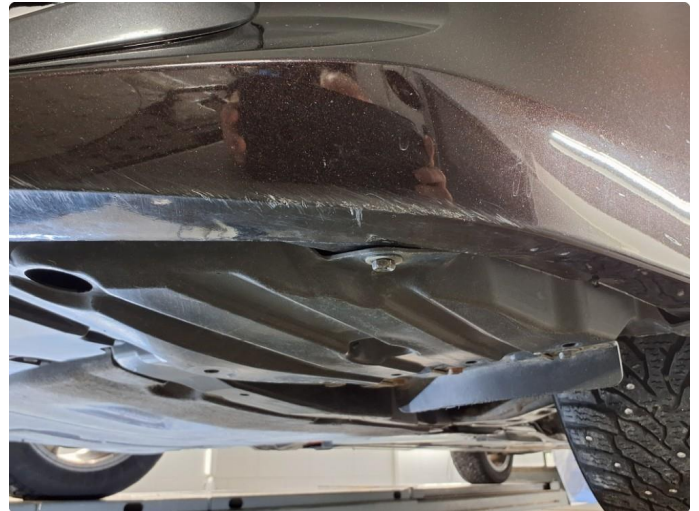
1.3 Noe skrubbskader i underkant
