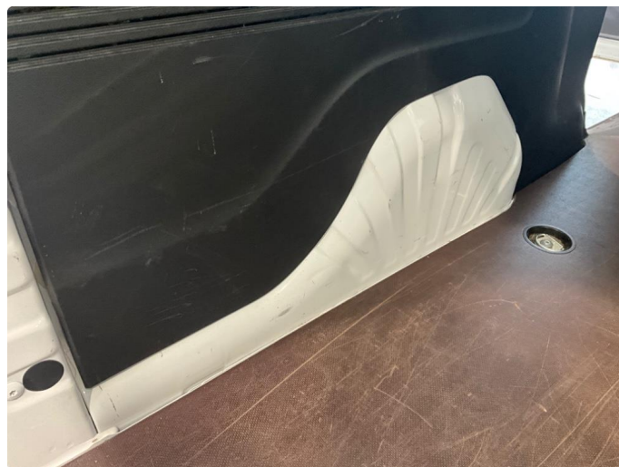
3.1 Generell slitasje i varerom. Ikke uvanlig mengde.
