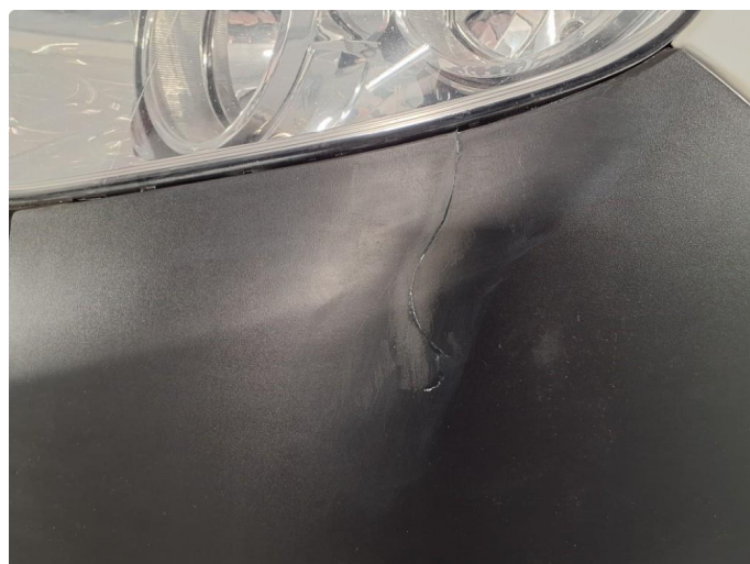
1.5 Liten sprekke i støtfanger
