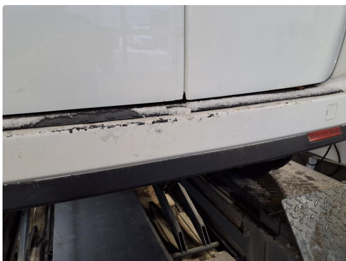
1.6 En del riper ned til grunning
