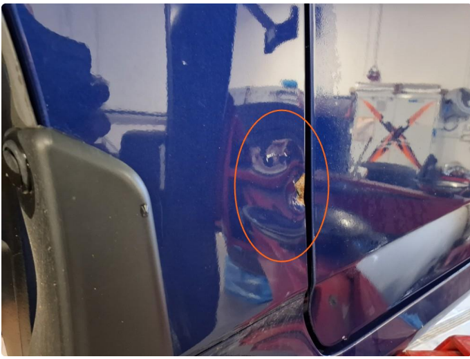
1.5 Bulk med lakkskade
