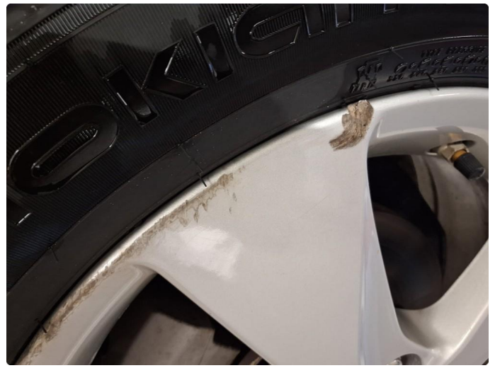
1.6 Kantkjørt felg - bruksmerker
