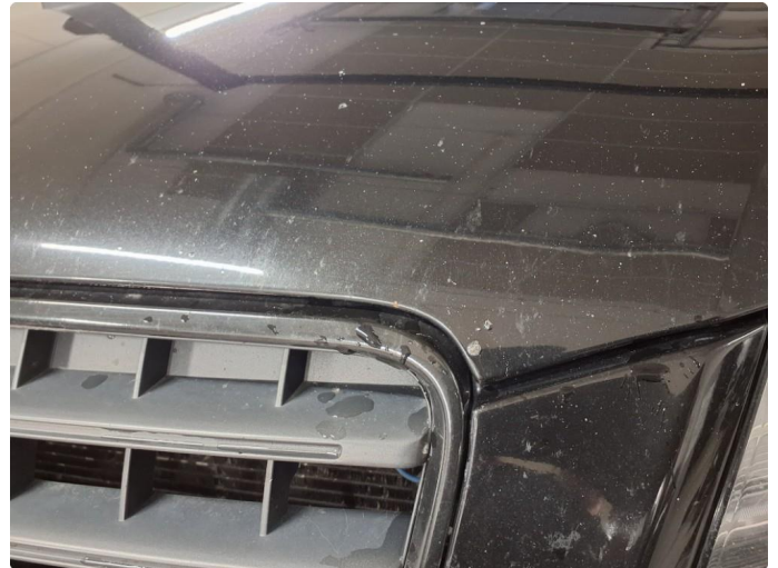
1.2 Noe steinsprut med rust
