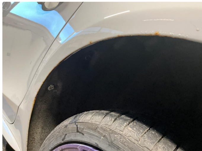
1.2 Rust i hjulbue.
