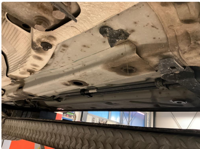
1.1 Beskyttelsesplate mangler under bilen. Høyre side.
