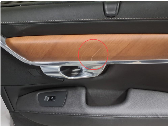
2.1 Skadet/merker etter utstyr
