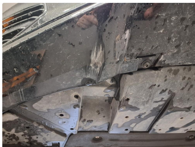
1.6 Skrubbskader i underkant av støtfanger foran.
