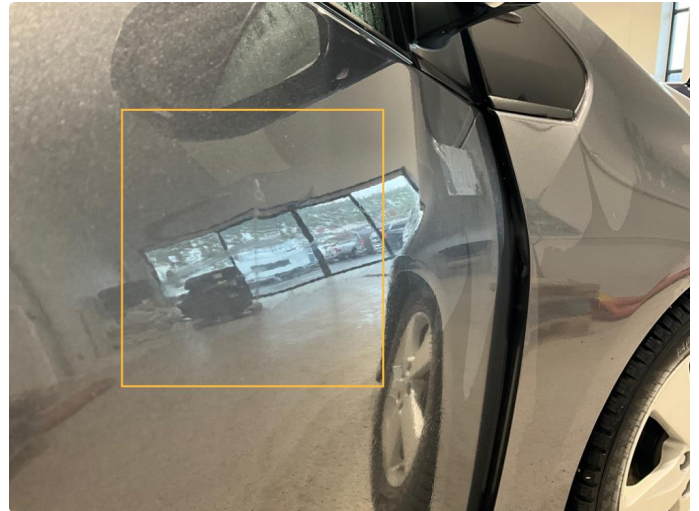
1.2 Svak bulk i dør. Høyre foran.
