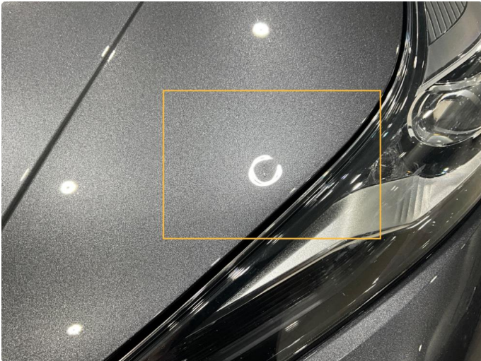
1.1 Svak bulk på panser. Venstre side.
