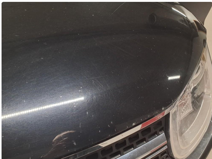
1.2 Steinsprut på panser
