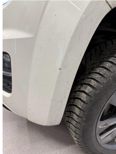
1.1 Noe riper og småbulker
