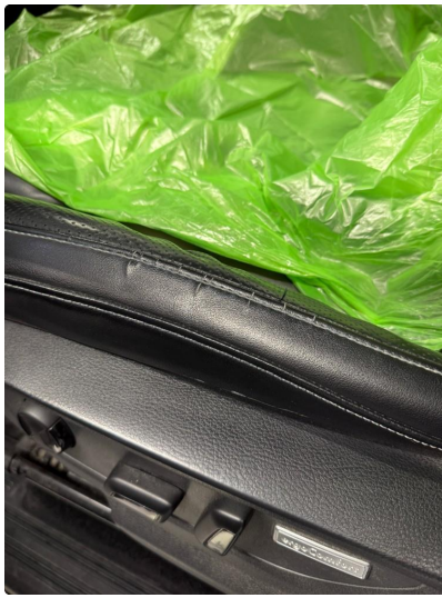
3.1 Skade på setetrekk
