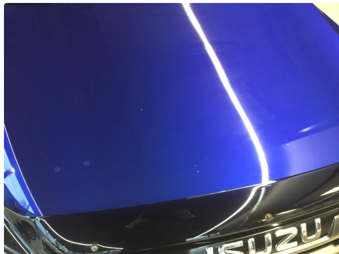
1.3 Steinsprut på panser
