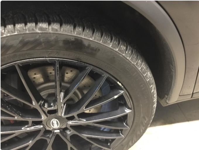
1.1 Noe kantkjørt, begge foran
