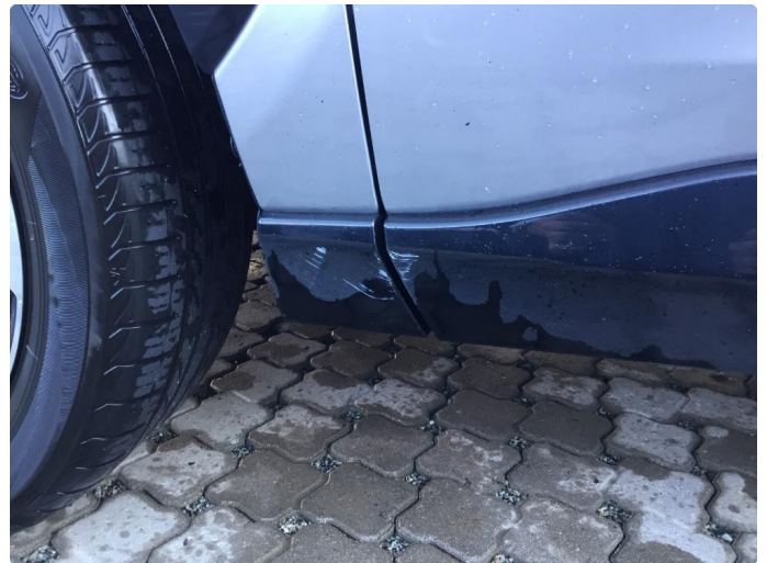
1.2 Ripe(r) ned til grunning
