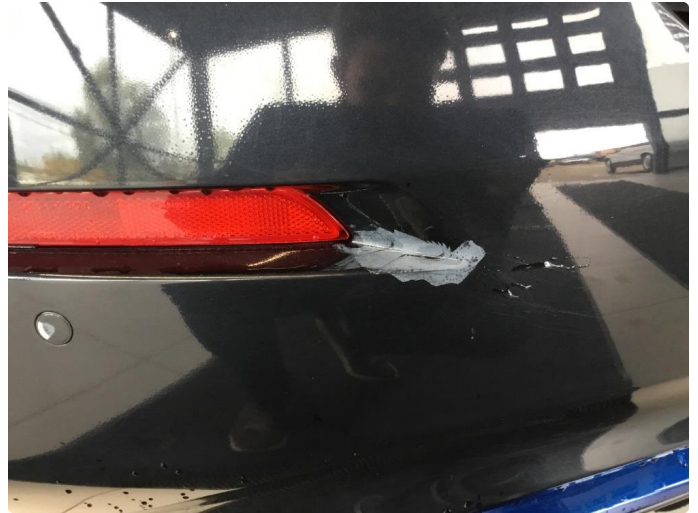
1.2 Lakk har falt av
