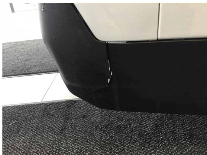
1.3 Sprukket i støtfanger bak
