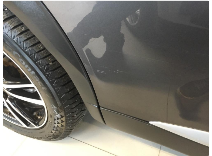
1.2 Ripe i lakk på høyre dør bak.
