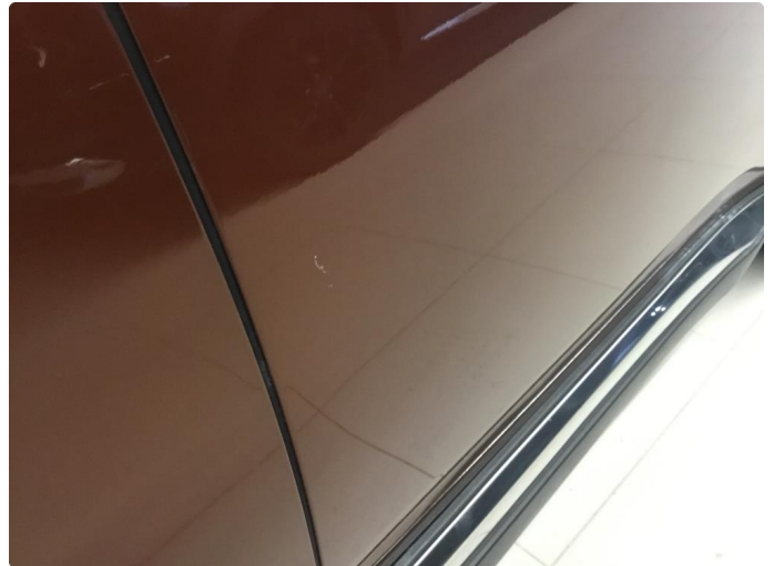
1.2 Ripe i lakk på høyre dør.
