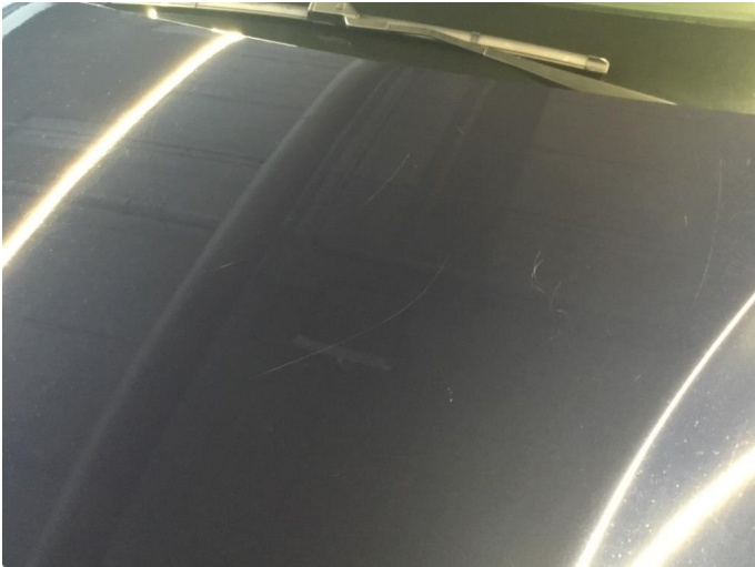
1.1 Ripe i lakk foran. Vanlig bruktslitasje
