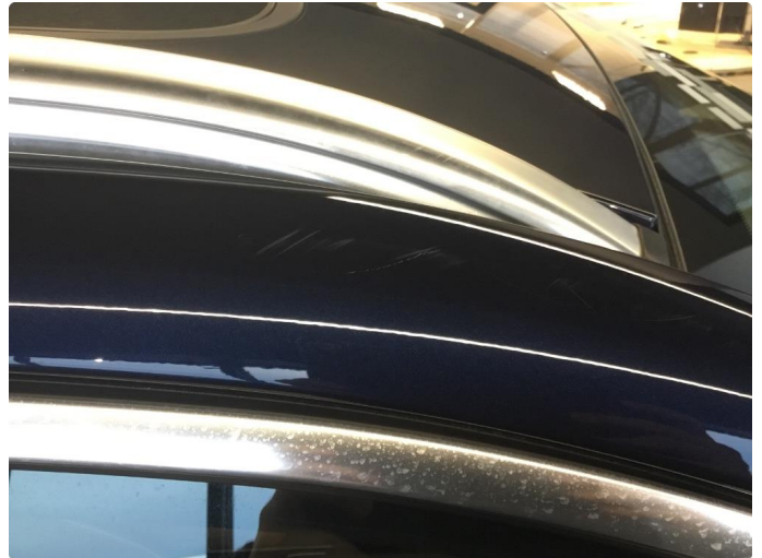
1.2 Ripe i lakk over døren på passasjersiden foran. Vanlig bruktslitasje
