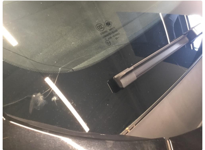
1.2 Sprekk på høyre side av frontruta
