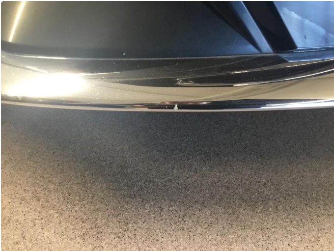
1.1 Sprekk på støtfanger
