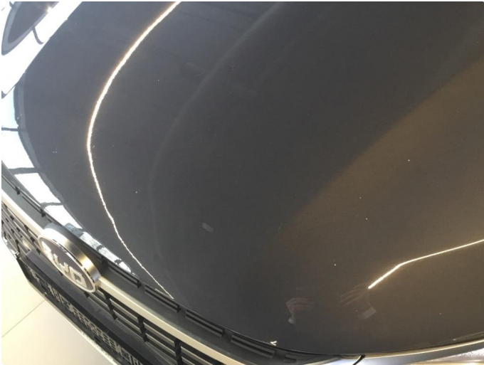
1.1 Diverse steinsprut på panser.
