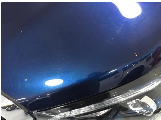
1.1 Noe steinsprut med rust
