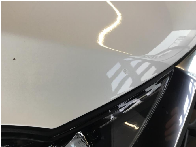
1.1 Liten lakkskade på panser
