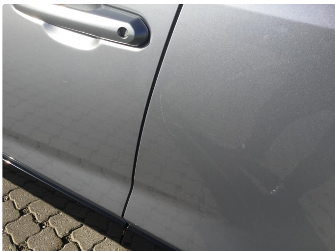
1.1 Ripe ned til grunning
