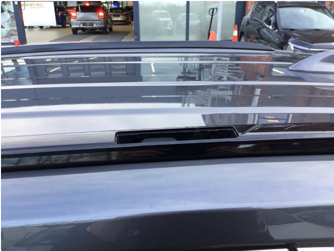
1.1 Deksler på tak/rails mangler
