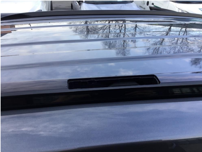
1.1 Deksler på tak/rails mangler
