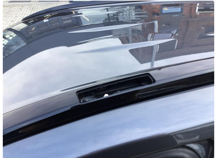
1.1 Deksler på tak/rails mangler
