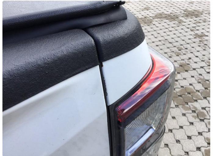
1.1 Ripe(r) ned til grunning
