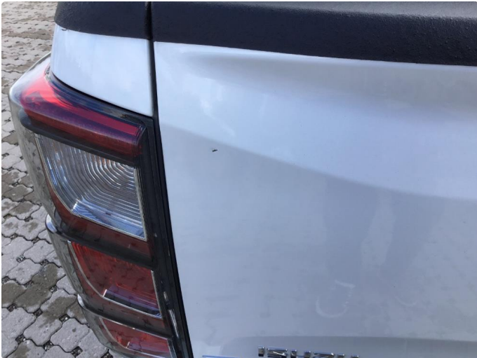
1.1 Ripe(r) ned til grunning
