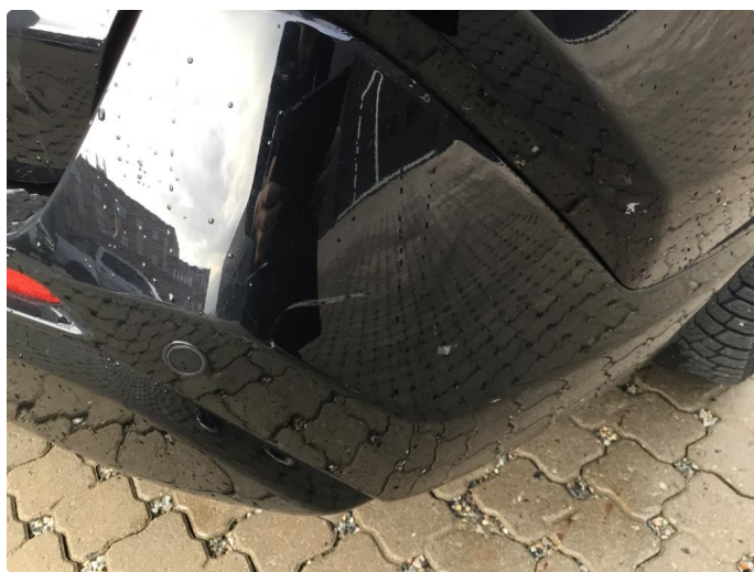
1.6 Ripe(r) ned til grunning
