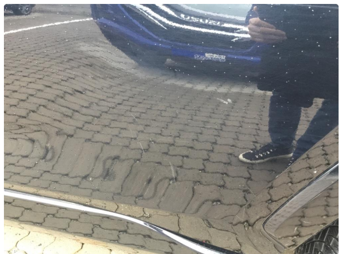
1.3 Ripe ned til grunning
