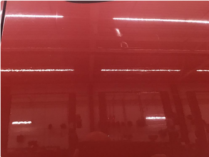
1.2 Ripe ned til grunning
