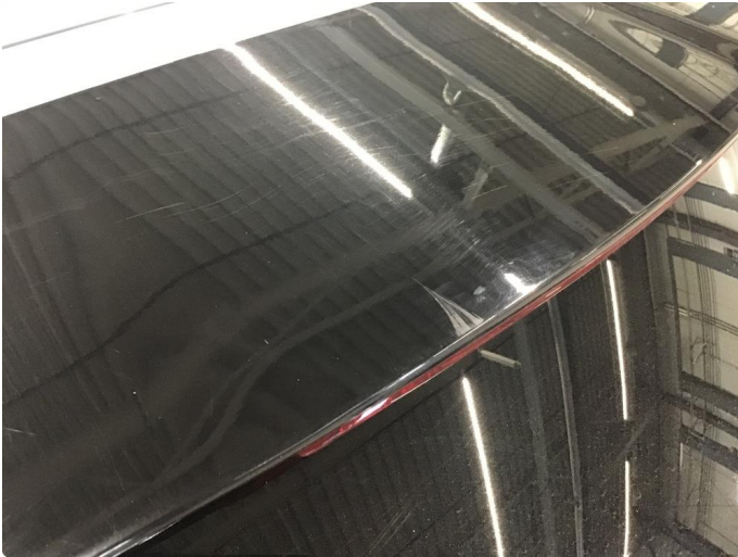
1.1 Ripe(r) ned til grunning
