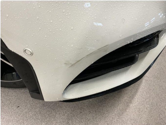
1.1 Ripe(r) ned til grunning (Bilde tatt før utbedring)
