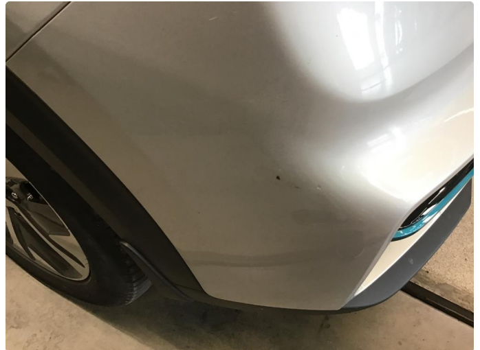
1.2 Ripe(r) ned til grunning
