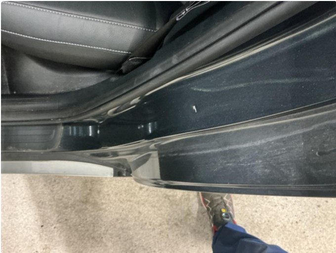
1.1 Bulk(er) med lakkskade
