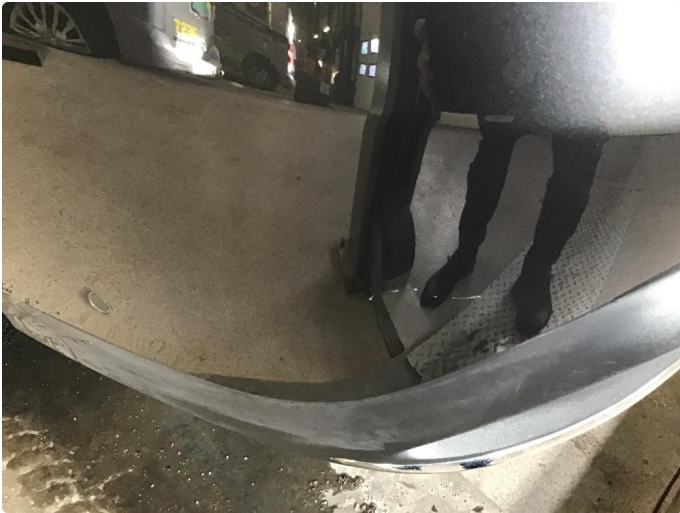
1.1 Ripe(r) ned til grunning
