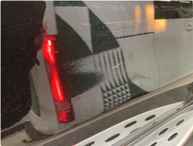
1.1 Ripe ned til grunning
