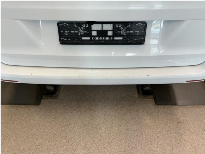
1.3 Ripe(r) ned til grunning
