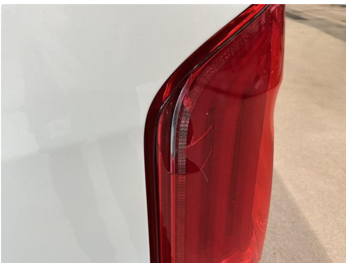
2.1 Defekt / sprukket glass
