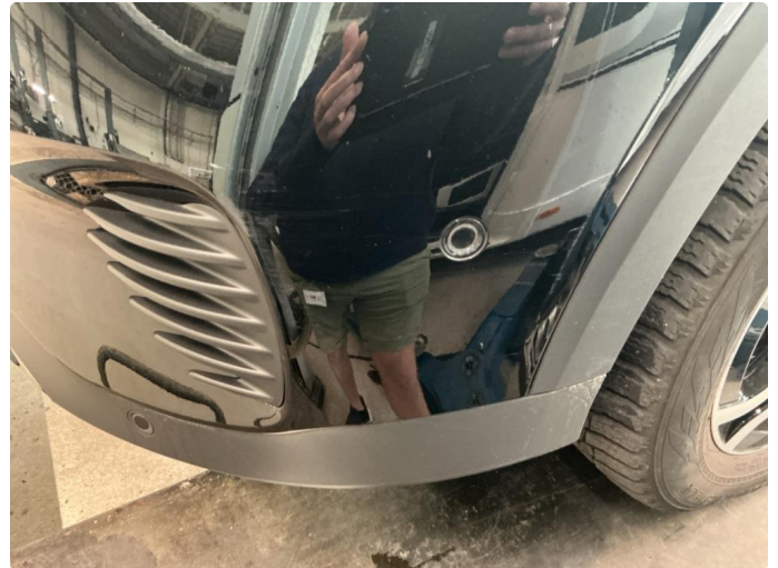
1.2 Ripe(r) ned til grunning
