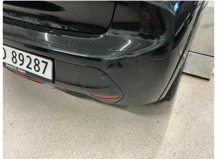
1.2 Ripe(r) ned til grunning
