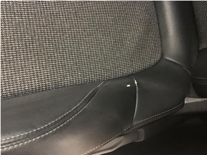
1.1 Skade på setetrekk
